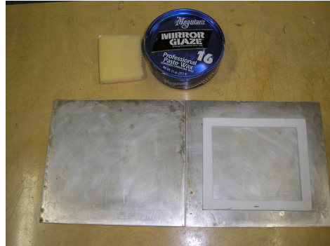
Figure 3 - Plaques en aluminium, contour en Teflon et cire de démoulage utilisés pour préparer les plaques d'adhésif massif.
