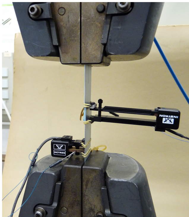
Figure 3 - Montage d'une éprouvette collée dans les mors manuels
