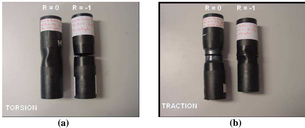
Figure III.2 - Éprouvettes rompues après des essais de fatigue en (a) torsion et (b) traction à R = 0 et R = -1 (l'éprouvette soumise à la traction à R = 0 a été coupée avec un cutter dans la zone strictionnée à la fin d'essai pour être démontée de la machine)
