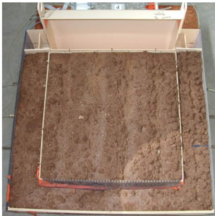
FIG. 2.3 – Structure du bac de 0,25 \text{ m}^2 .
