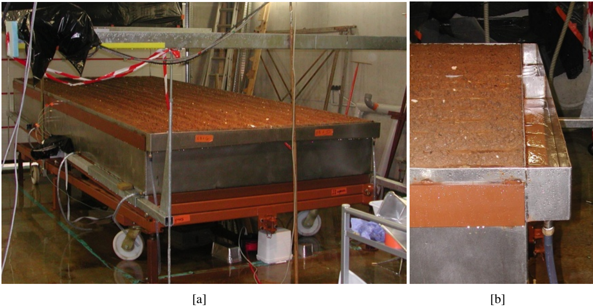
FIG. 2.4 – Structure du bac de 5 \times 2 \text{ m}^2 . Vue générale depuis l'aval présentant l'ensemble du bac constitué de deux parties de 5 \times 1 \text{ m}^2 (a). Détail du système de recueil du ruissellement (b). Photos : Frédéric DARBOUX
