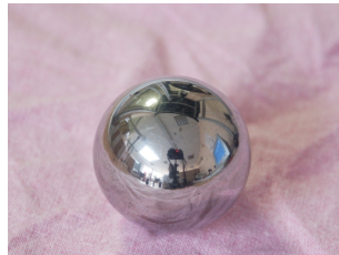
Figure 5.14 – Bille calibrée employée pour l’évaluation du système d’acquisition.
