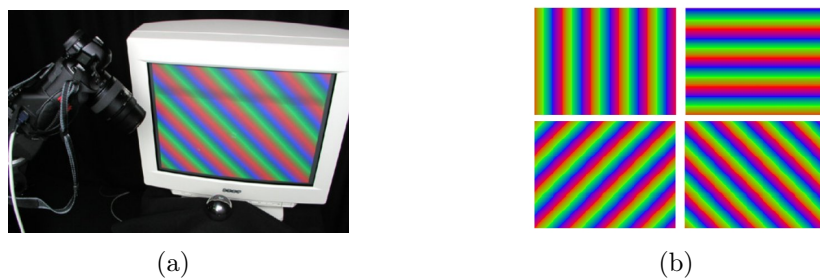
Figure 2.44 – Système proposé par Tarini et al. : (a) montage, (b) motifs utilisés [Tarini et al., 2005].
