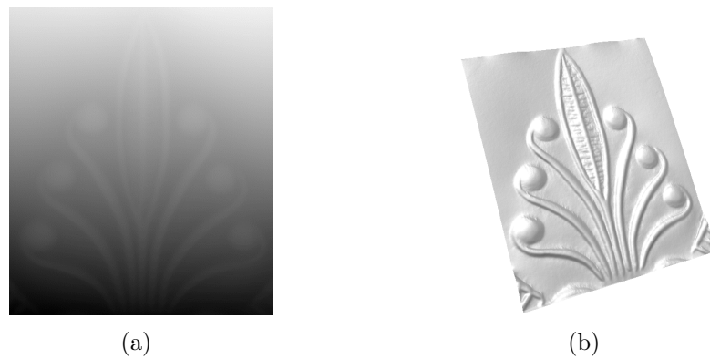
Figure 5.28 – Reconstruction de la surface : (a) image de profondeur, (b) image de rendu.
