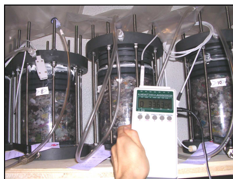
Mesure de la température des déchets à partir de capteurs de température
