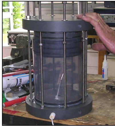
Préparation des cellules; installation des sondes de température dans les cellules et des joints isolants sur les couvercles
