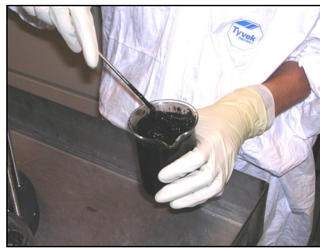
Liquéfaction des boues en les mélangeant avec 100ml de lixiviat
