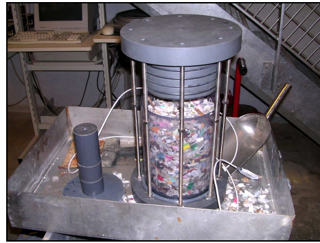
Remplissage des cellules et application de la charge verticale pour compacter les déchets
