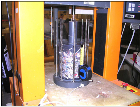
Remplissage des cellules et application de la charge verticale pour compacter les déchets
