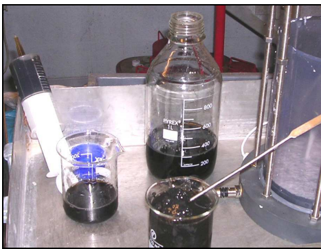
Liquéfaction des boues en les mélangeant avec 100ml de lixiviat
