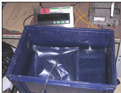
Production de biogaz et quantification du volume de biogaz produit dans un bassin d'eau (par poussée d'Archimède)
