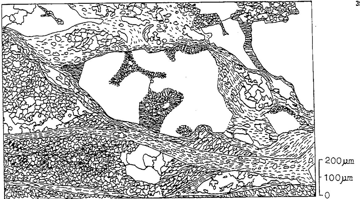
Fig.III.7 - Grès grossier gris permien, échantillon AIC8, lame mince. Élément de quartz rhyolitique cassé à profonds "golfes de corrosion".
