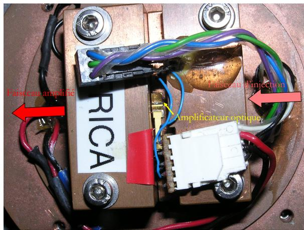
FIGURE 2.16 – Photographie d'ensemble du montage de l'amplificateur optique. Le "tapered amplifier" est disposé entre deux lentilles (situées dans les culots) utilisées pour le couplage optique à l'entrée et pour la collimation à la sortie. Le système est régulé en température par un élément Peltier qui est situé en dessous du support de la diode.
