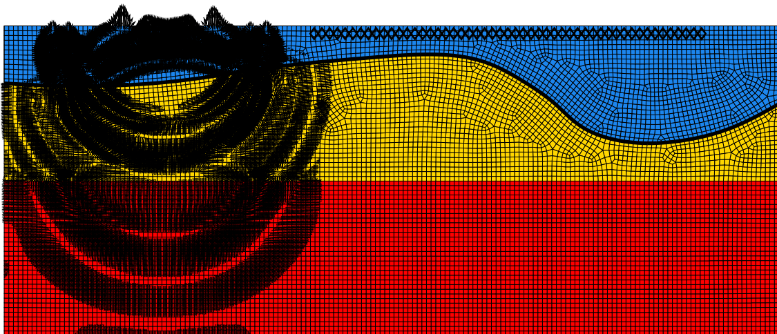
Fig. 3.15 – Propagation d’ondes sismiques dans un modèle à trois couches avec une couche fluide surmontant deux couches solides. L’instantané est représenté au temps t = 0,560 s. Les 51 récepteurs sont représentés par des losanges. La couche bleue représente la couche fluide tandis que les couches jaune et rouges sont les couches solides.
