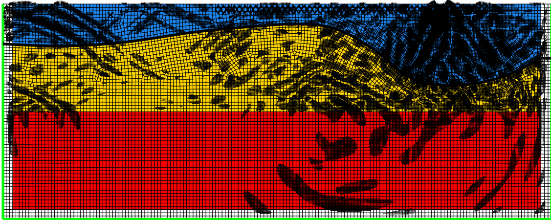
Fig. 4.19 – Propagation d’ondes sismiques dans un modèle à trois couches avec une couche fluide surmontant deux couches solides. L’instantané est pris au temps t = 1,120 s. Les 51 récepteurs sont représentés par des losanges. La couche bleue représente le fluide tandis que les couches jaune et rouges sont des couches solides et les zones blanches représentent les couches absorbantes.
