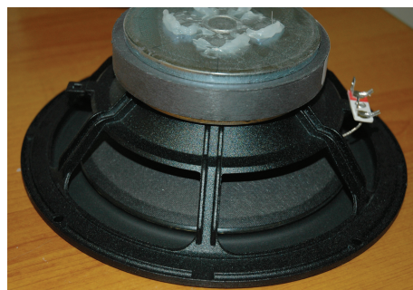
FIGURE 1.6 – Haut-parleur CA21 REX, membrane en cellulose
