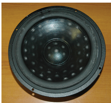
FIGURE 1.6 – Haut-parleur CA21 REX, membrane en cellulose
