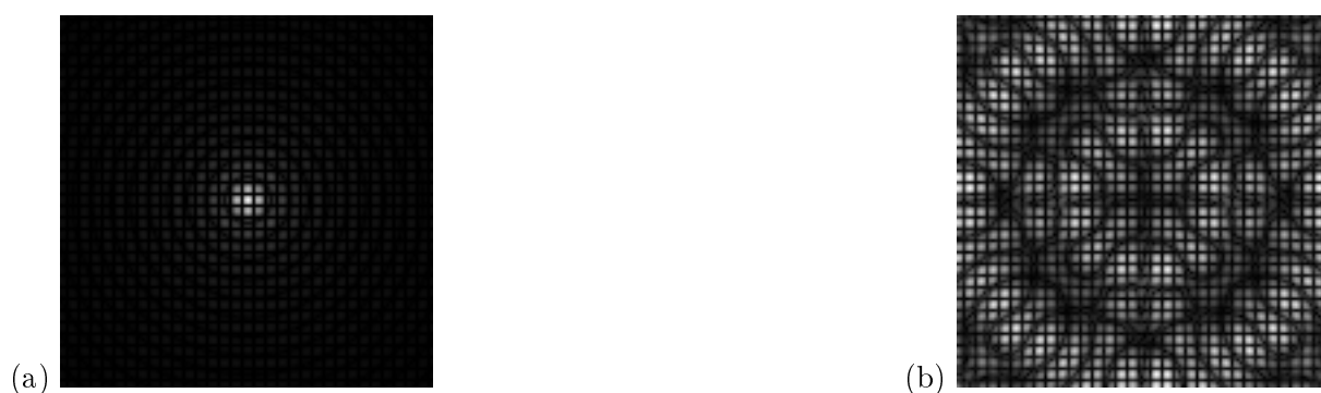
FIG. 3.8 – Simulation numérique des PSF de l'instrument CORONA attendues avec une pupille d'entrée à 4 trous : (a) PSF de référence, (b) PSF coronographiée.
