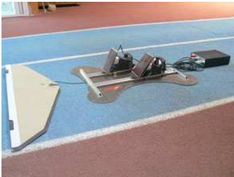
Figure 22 : Starting-blocks instrumentés développés au sein du Laboratoire de mécanique des solides.
