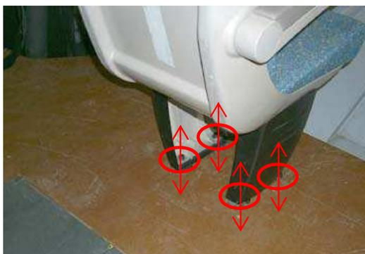
**Figure 2-12** : mesure d'efforts siège/sol
