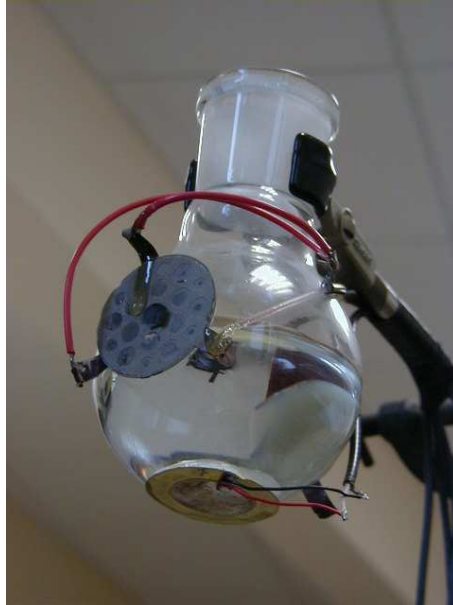
FIG. 2.3: Le ballon utilisé lors de nos expériences : deux transducteurs acoustiques (pastilles piézoélectriques) de puissance sur les bords du ballon génèrent le champ stationnaire, tandis qu'un petit transducteur sous le ballon permet de connaître le champ acoustique à la surface du ballon et donc de régler la fréquence du champ d'excitation à la résonance du ballon.
