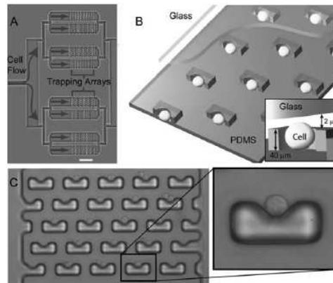
**Figure 5.1 - Filtres en PDMS permettant l'immobilisation mécanique d'une cellule.**<sup>237</sup>
