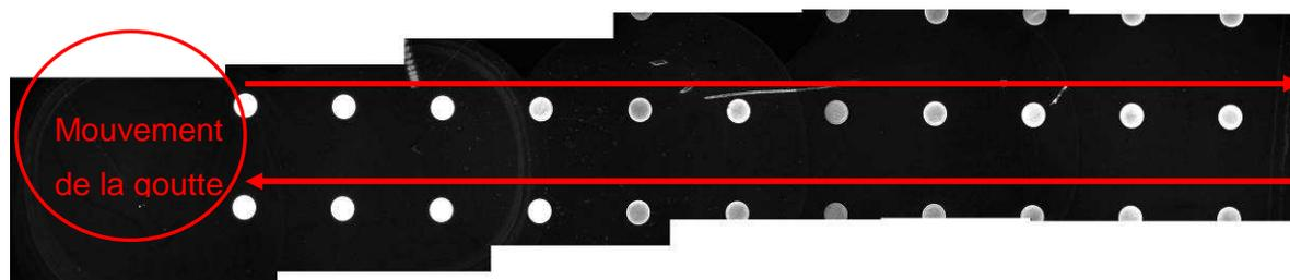
**Figure 4.10. Acquisitions de microscopie à fluorescence sur nanofils de silicium superhydrophobes présentant des plots superhydrophiles de diamètres 150 $\mu\text{m}$  et espacés de 400  $\mu\text{m}$  après déplacement d'un peptide fluorescent.**
