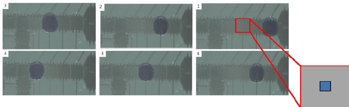
Figure 4.12. Photos d'un déplacement successif d'une goutte entre les électrodes et les nanofils de silicium. En dessous d'une électrode (1,7mm) se trouve un plot de nanofils (100 $\mu\text{m}$ ) superhydrophile défini dans le capot de nanofils superhydrophobes.
