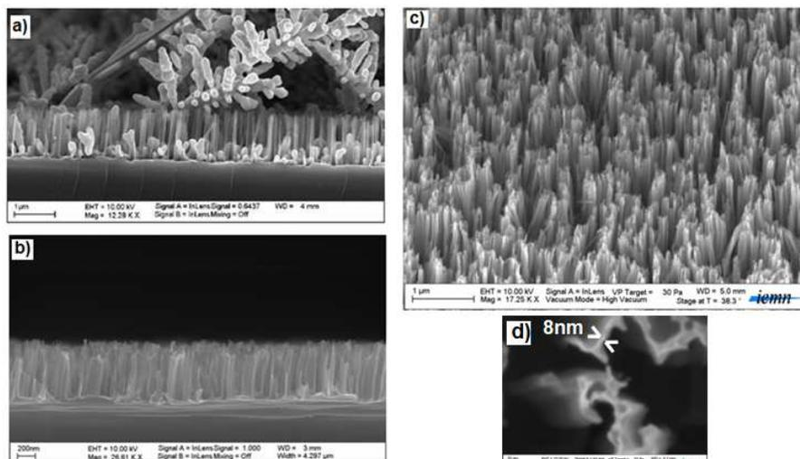
Figure 2.5. Images MEB de nanofils de silicium réalisés par gravure chimique HF/AgNO<sub>3</sub> : a) avant dissolution de l'argent, b) après dissolution de l'argent (vue en coupe), c) après dissolution de l'argent (vue tiltée), d) zoom sur les nanofils de silicium (vue de dessus).
