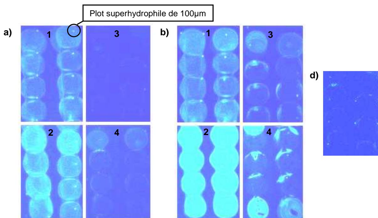
**Figure 4.13.** Images de fluorescence acquises suite au déplacement du mélange de peptide a) à 50 femtomol/ $\mu$ l et b) à 150 femtomol/ $\mu$ L pour 1) 20 allers-retours à  $98 \text{ mm.s}^{-1}$ , 2) 20 allers-retours à  $17 \text{ mm.s}^{-1}$ , 3) 1 aller à  $17 \text{ mm.s}^{-1}$ , 4) 1 aller à  $98 \text{ mm.s}^{-1}$  avec une tension moyenne de  $65 V_{\text{max}}$ . L'image en d) est la même que l'image a.3 mais le contraste est augmenté par rapport aux autres images.
