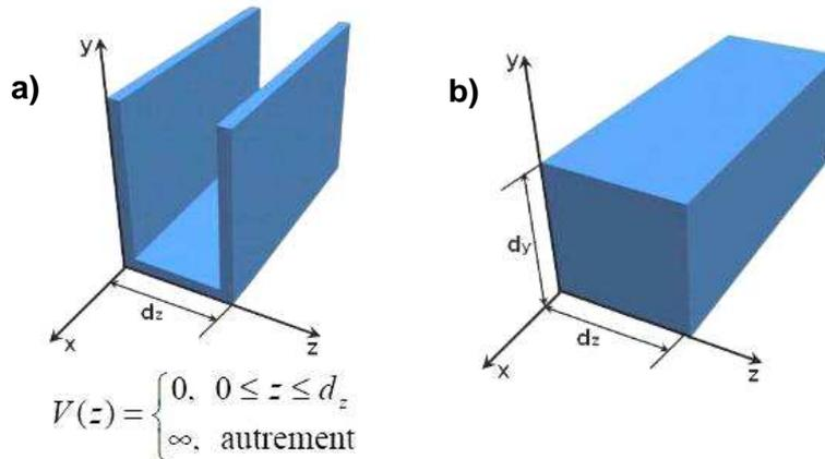
**Figure 2.20. a) Modèle d'un puits quantique infini: l'électron est confiné dans la direction z, sur une épaisseur de largeur  $d_z$ . b) Modèle de fil quantique infini: l'électron est confiné dans les directions z et y).**<sup>94</sup>
