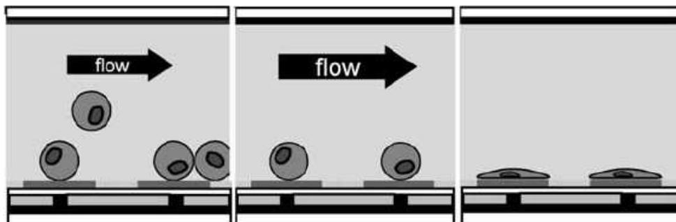
**Figure 5.2 - Principe de l'immobilisation de cellules par diélectrophorèse :**
