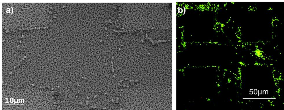
**Figure 5.19. Image MEB<sup>15</sup> (a) et en fluorescence (b) des spores *Bacillus Cereus* après incubation avec les surfaces de nanofils de silicium renfermant des zones superhydrophiles de 50 μm<sup>2</sup> entourées de zones superhydrophobes.**
