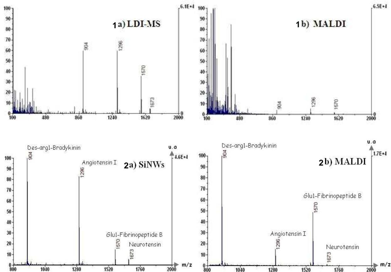
**Figure 3.7. Spectres obtenus en filtrant les ions de masses inférieures à 800m/z (2a et 2b) ou non (1a et 1b) avec les techniques a) LDI-MS b) MALDI sur nanofils de silicium pour l'analyse de peptides standards dilués à 50 femtomol/ $\mu$ l (sauf la neurotensin à 10 femtomol/ $\mu$ l) dans une solution aqueuse de citrate d'ammonium à 1mM.**
