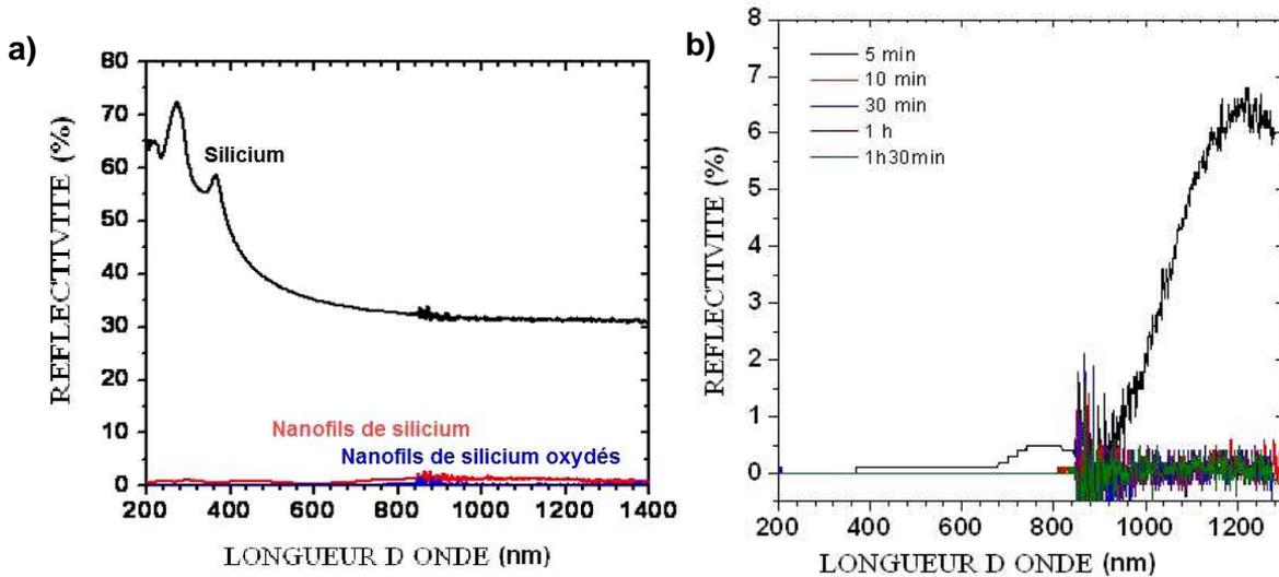
**Figure 3.9. a) Spectre de réflectivité du silicium, des nanofils de silicium synthétisés par voie chimique ( $\text{HF}/\text{AgNO}_3$  à 5.25/0.02M) et des nanofils de silicium oxydés synthétisés par voie SLS. B) Spectre de réflectivité des nanofils de silicium synthétisés par voie chimique ( $\text{HF}/\text{AgNO}_3$  à 5.25/0.02M) avec différents temps d'attaque (5, 10, 30, 60, 120 min).**
