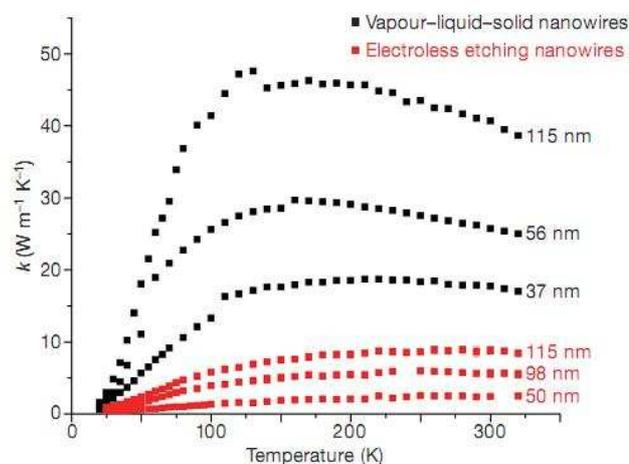
**Figure 2.25. Valeurs de la conductivité thermique de nanofils de silicium en fonction de la température, du diamètre des nanofils pour des nanofils synthétisés par voie VLS et par gravure chimique sans électrode.**<sup>126</sup>
