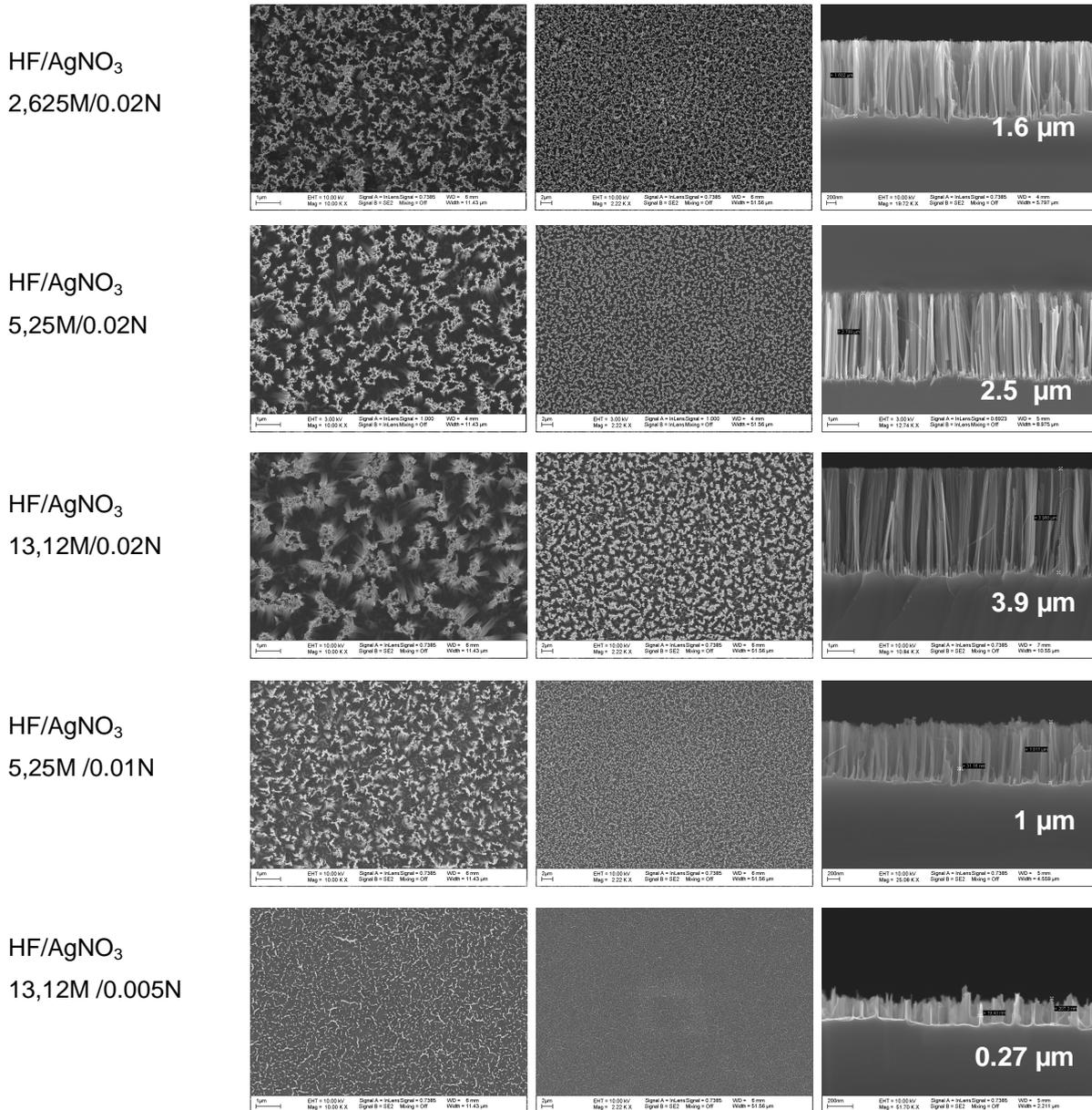
**Figure 2.8. Images MEB : Vues de dessus (grossissement 10KX à gauche et 2,22KX au centre) et en coupe des nanofils de silicium synthétisés par voie chimique en fonction de plusieurs concentrations en HF/AgNO<sub>3</sub> de la solution d'attaque.**
