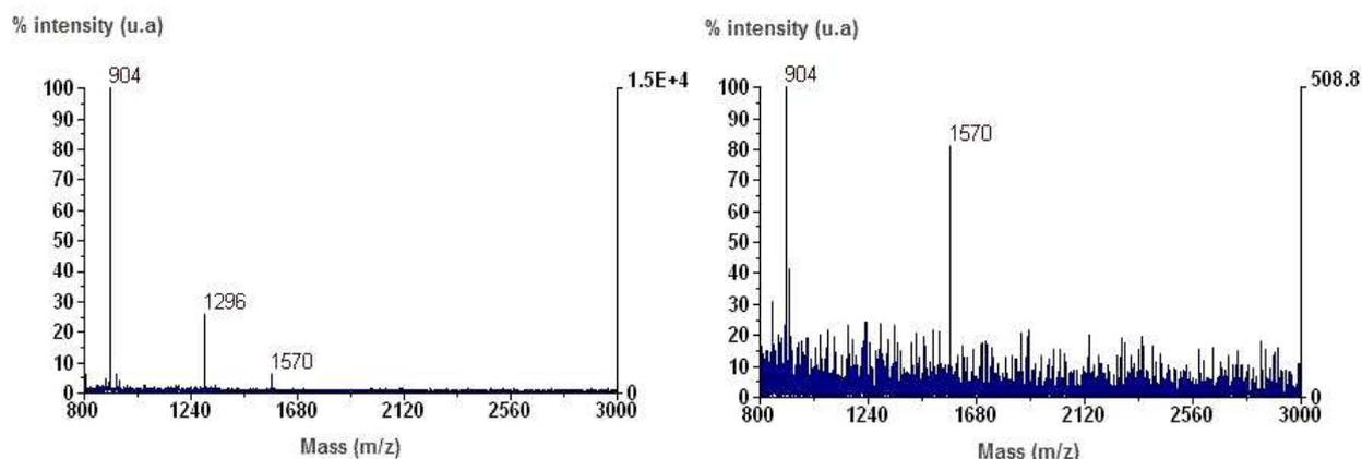
**Figure 4.16.** Spectre d'analyse (10 tirs laser en moyenne) LDI-MS du mélange de peptides déposé par déplacement EWOD d' $1\ \mu\text{L}$  à 50 femtomol dans 1 mM de citrate d'ammonium a) dans les plots de nanofils de silicium superhydrophiles, b) en dehors des plots.
