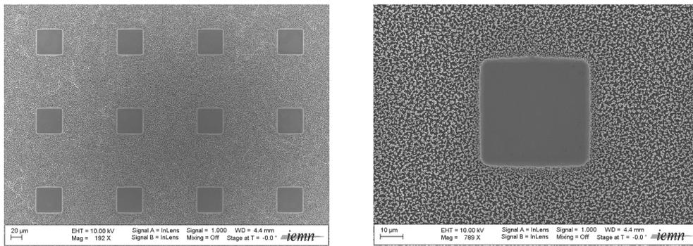
**Figure 5.14.** Image MEB d'un support dédié pour la localisation de cellules sur des plots de silicium plats hydrophiles, entourés de nanofils de silicium superhydrophobes.
