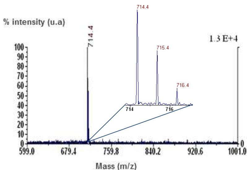
Figure 4.11. Spectre d'analyse LDI-MS sur un plot superhydrophile de nanofils de silicium où le peptide Lys-Arg-Rhodamine ( $m/z=714.4$ ) est déposé par déplacement EWOD d'un microlitre à 150 femtomol dans 1mM de citrate d'ammonium.
