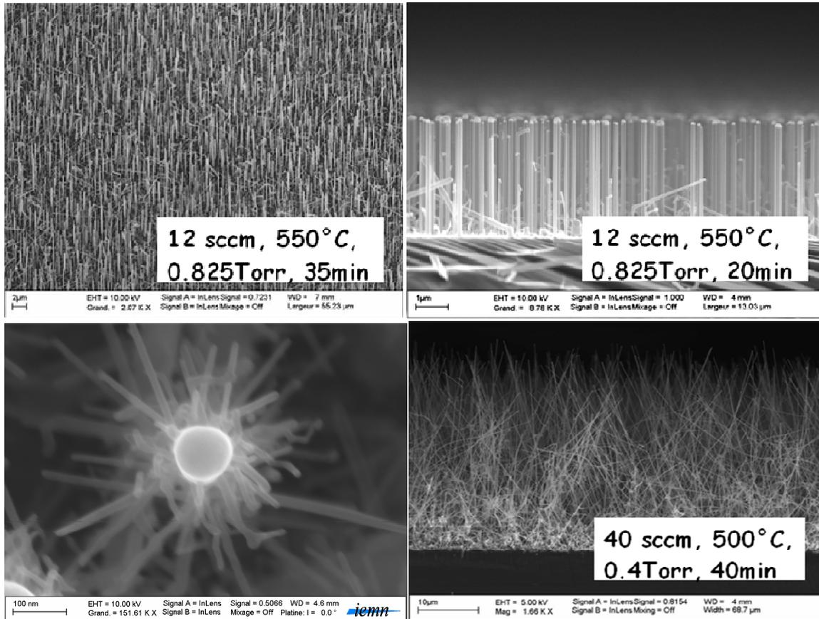
**Figure 2.2.** Images de microscopie à balayage électronique (MEB) de nanofils de silicium synthétisés par VLS au laboratoire IEMN.
