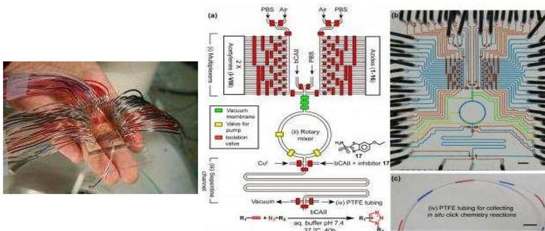
Figure 4.1. Dispositif microfluidique d'un laboratoire sur puce : photo et design.<sup>203</sup>
