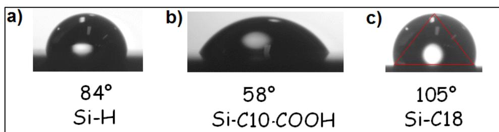
**Figure 2.17. Angles de contact d'une goutte d'eau d'1µl sur des surfaces de silicium : a) après traitement à l'acide fluorhydrique, b) après hydrosililation de l'acide décanoïque et c) après hydrosililation de l'octadécène.**
