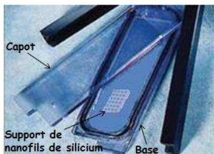
**Figure 4.5. Image de la chambre à incubation. Le mélange de méthylation est 'piégé' entre le support de nanofils de silicium et le capot.**
