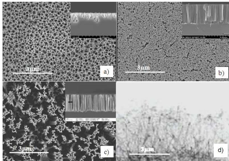
**Figure 3.5. Images MEB de a) silicium poreux, b) nanofilaments de silicium utilisé en DIOS par Tsao et al., et de nanofils de silicium c) synthétisés par voie chimique au sein du laboratoire (vues de dessus et en coupe), d) synthétisés par voie VLS par Go et al. (vue en coupe).**
