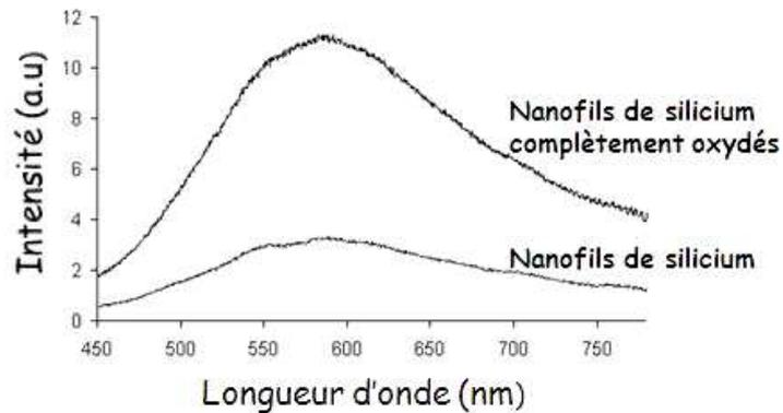
**Figure 3.10. Spectre de photoluminescence des nanofils de silicium, fabriqués par voie chimique, avant et après oxydation thermique (mesure à température ambiante avec une source d'excitation laser He-Cd à 325 nm).**
