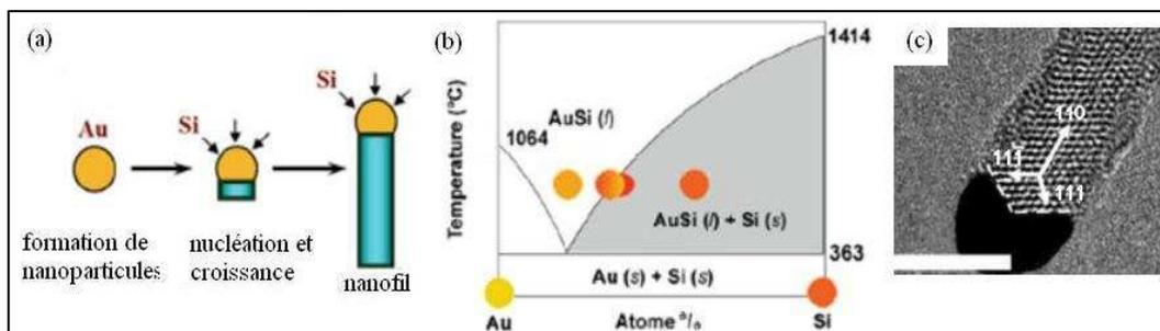
**Figure 2.1. (a) Processus de croissance VLS d'un nanofils de Si, (b) Diagramme de phase Si, (c) Image de microscopie électronique en transmission à haute résolution (HRTEM) d'un nanofil de silicium avec son catalyseur, la barre d'échelle vaut 5 nm.<sup>71</sup>**
