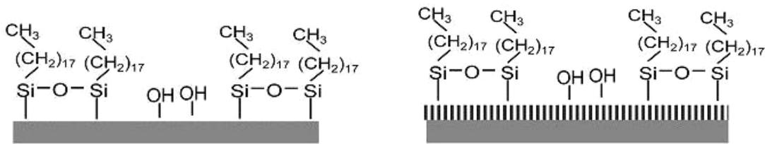
**Figure 5.16. Schéma d'une surface plane de silicium avec des régions hydrophiles (terminaison OH) et des régions hydrophobes (terminaison Si-(CH<sub>2</sub>)<sub>17</sub>-CH<sub>3</sub>) à gauche, et d'une surface de nanofils de silicium avec des régions superhydrophiles (terminaison OH) et des régions superhydrophobes (terminaison Si-(CH<sub>2</sub>)<sub>17</sub>-CH<sub>3</sub>) à droite.**
