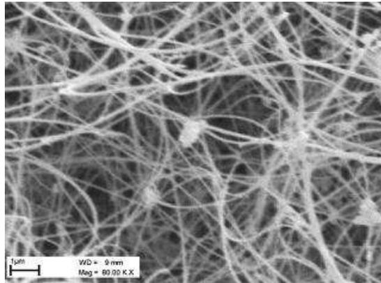
**Figure 3.8. Image MEB des nanofils de silicium étudiés par Luo et al.<sup>157</sup> pour mesurer l'énergie interne nécessaire à la désorption d'ions thermomètres.**
