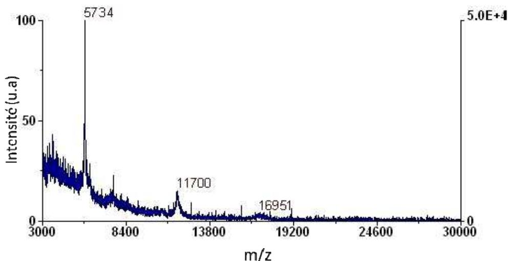
**Figure 3.4.** Spectre d'analyse du mélange de l'insulin bovine (5734 Da), la thioredoxin (protéine de Escherichia coli, 11700 Da), et l'apomyoglobin (16952 Da) par LDI-MS sur nanofils de silicium silanisés par OTS puis exposés à l'UV/ozone.
