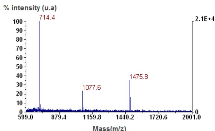
**Figure 4.15.** Spectre d'analyse (10 tirs laser en moyenne) LDI-MS du mélange de peptides Lys-Arg-Rhodamine ( $m/z=714.4$ ), du peptide de séquence  $\text{NH}_2\text{-SILKEPVHGV-NH}_2$  ( $m/z=1077.6$ ), et du peptide de séquence  $\text{Ac-GGIAQDFKTLRGG-NH}_2$  ( $m/z=1475.8$ ) déposés par déplacement EWOD d' $1\ \mu\text{L}$  à 50 femtomol dans 1 mM de citrate d'ammonium. Le spectre est identique qu'il soit réalisé dans ou en dehors des plots de nanofils de silicium superhydrophiles.
