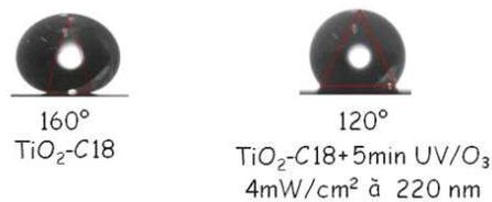
**Figure 3.22. Angle de contact d'une goutte d'1 $\mu\text{l}$  d'eau sur une surface de nanotubes de  $\text{TiO}_2$  silanisée par OTS avant (gauche) et après irradiation UV/ozone (droite).**
