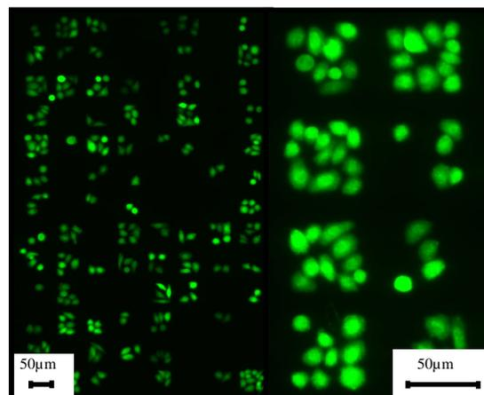
**Figure 5.5. Image en fluorescence (logiciel Axiovision 40 v4.0) des cellules CHO K1 après 24 h d'incubation dans le milieu de culture Ham F12 avec les surfaces de nanofils de silicium présentant des zones carrées superhydrophiles, entourées de zones superhydrophobes.**
