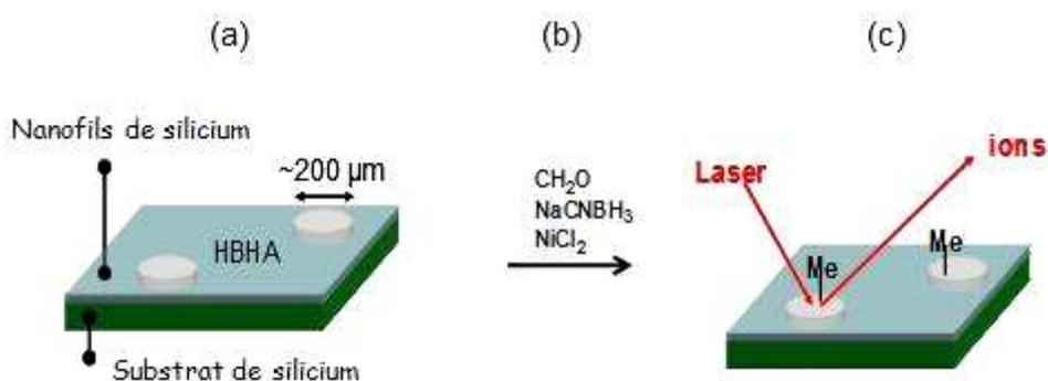
**Figure 4.4. (a) Immobilisation des peptides dérivés de la protéine 'HBHA' sur une surface de nanofils de silicium, (b) réaction des peptides avec les agents de méthylation, (c) analyse des peptides méthylés par spectrométrie de masse par désorption/ionisation laser.**
