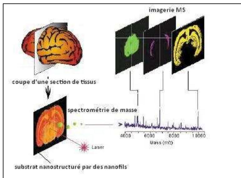
**Figure 1.15. Principe de l'imagerie par spectrométrie de masse.**
