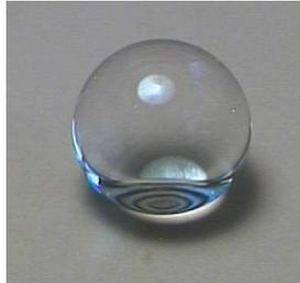
**Figure 2.18. Photo d'une goutte d'eau sur une surface superhydrophobe.**
