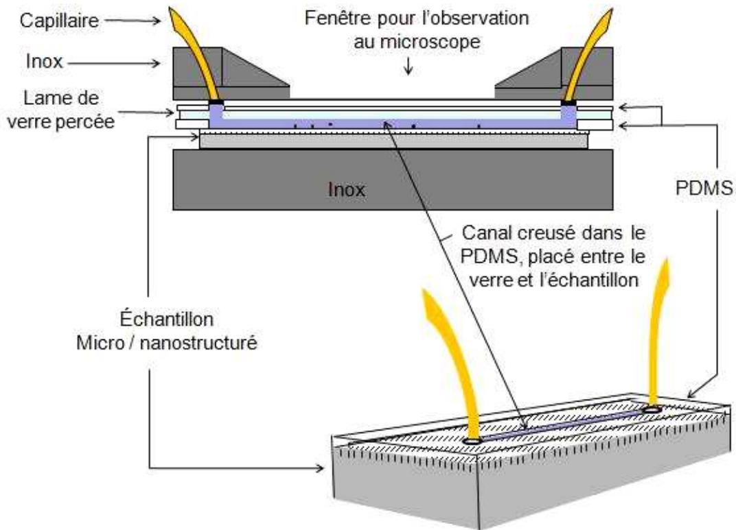
**Figure 5.20. Dispositif microfluidique permettant de mesurer la pression fluïdique dans le canal nécessaire pour décrocher les spores de l'échantillon Micro/nanostructuré.**
