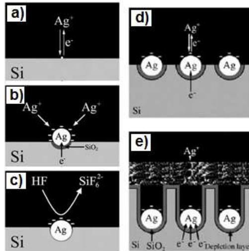
Figure 2.4. Schéma de principe de la réalisation de nanofils de silicium par gravure chimique HF/AgNO<sub>3</sub>.<sup>75</sup>
