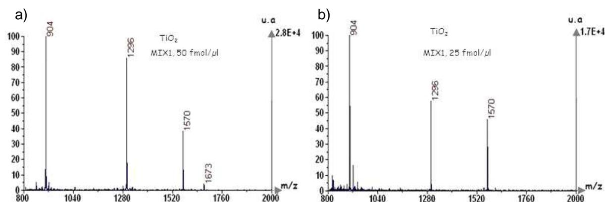
**Figure 3.23. Spectres obtenus en LDI-MS avec le support de nanotubes de  $\text{TiO}_2$  optimal pour l'analyse de peptides standards dilués à 50 femtomol/ $\mu\text{L}$  en a) et à 25 femtomol/ $\mu\text{L}$  en b) dans une solution aqueuse de citrate d'ammonium à 1mM. NB : La neurotensin est 5 fois plus diluée dans le mélange, sa limite de détection sur le spectre de gauche est donc de 10 femtomol/ $\mu\text{L}$ .**
