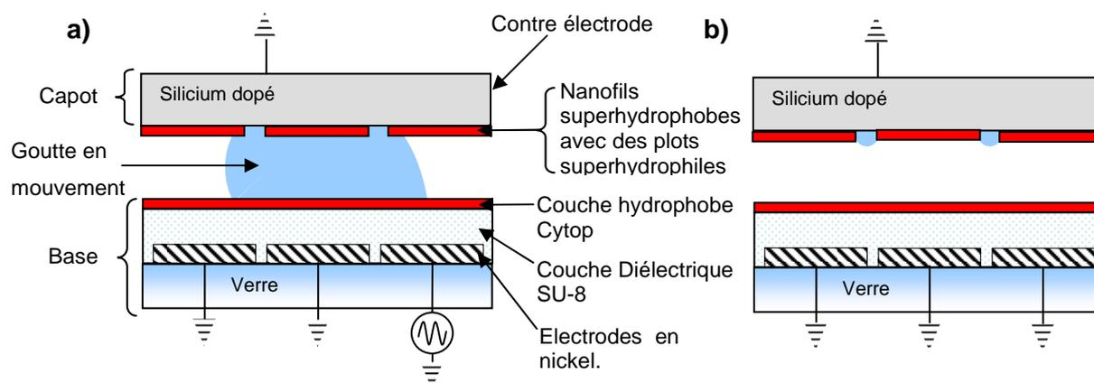
**Figure 4.8. Schéma du microsystème EWOD pour le déplacement de microgouttes : a) déplacement d'une goutte ( $1 \mu\text{L}$ ) entre la base et le capot, b) dépôt de gouttelettes contenant les analytes dans les plots superhydrophiles du capot pour une analyse LDI-MS.**
