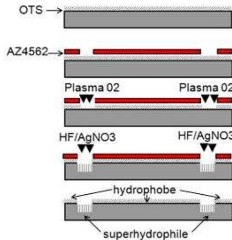
Figure 4. Etapes de préparation d'une surface superhydrophile/hydrophobe
