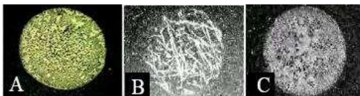
**Figure 1.7. Cristallisation des matrices<sup>24</sup> : a) Acide  $\alpha$ -cyano-4-hydroxycinnamique (HCCA), b) Acide 2,5-dihydroxybenzoïque (DHB), c) Acide Sinapinique (SA).**
