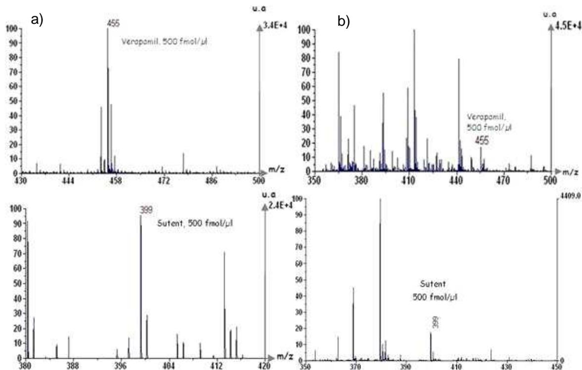
**Figure 3.24.** Spectres de masse obtenus a) en LDI-MS sur nanotubes de  $TiO_2$ , b) en MALDI pour la détection du verapamil ( $m/z = 455$ ) et du sutent ( $m/z=399$ ) à  $500 \text{ fmol}/\mu\text{l}$ .
