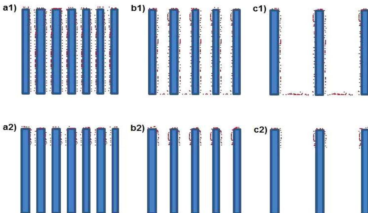
**Figure 3.13. Schéma de différentes densités de nanofils de silicium (a, espacement des fils de 10 à 30 nm ; b, espacement des fils de 30 à 50 nm ; c, espacement des fils de 50 nm à 2 µm) et de l'infiltration des peptides selon que les nanofils sont modifiés avec un silane hydrophobe (2) ou non (1).**
