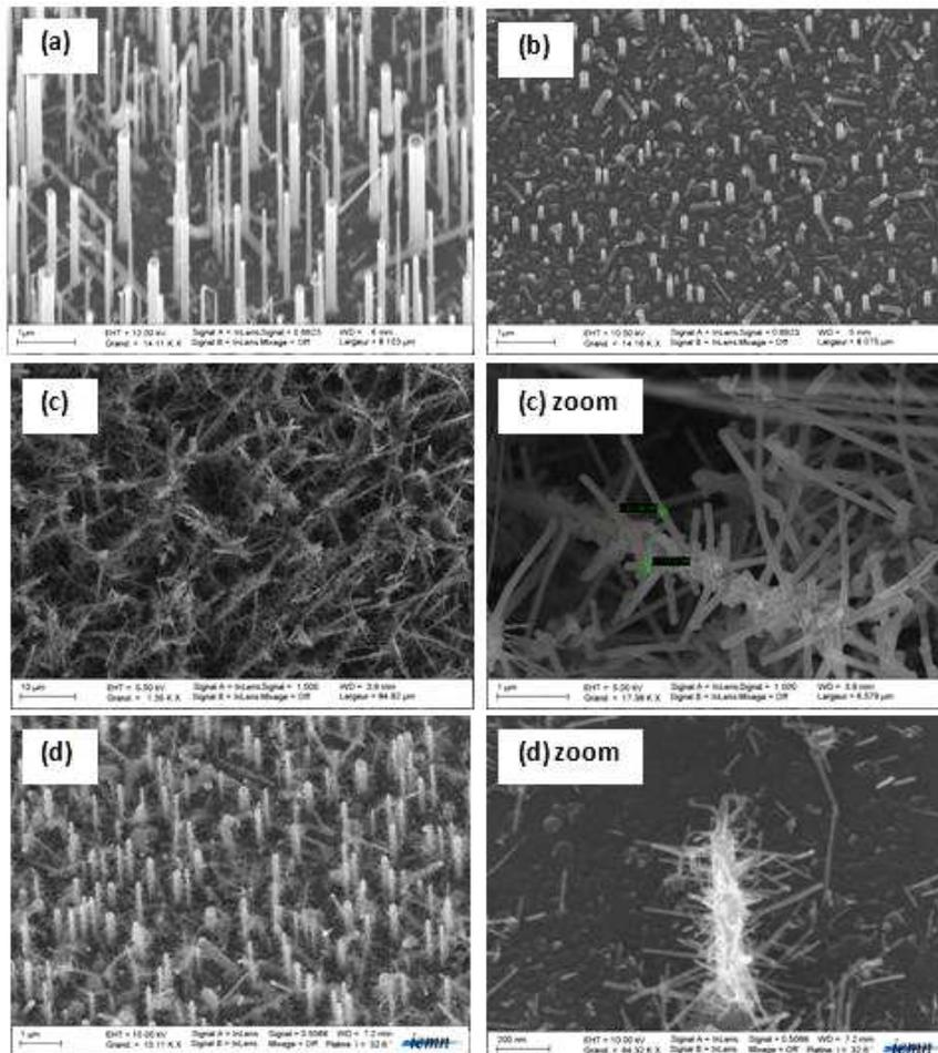
**Figure 2.3. Images MEB : vues inclinées des nanofils de silicium synthétisés par VLS selon différents paramètres avec pour grossissements a) 15KX (barre d'échelle 1µm), b) 15KX (barre d'échelle 1µm) c) 1.3KX (barre d'échelle 12µm), zoom 17KX (barre d'échelle 1µm), d) 10KX (barre d'échelle 1µm), zoom 64KX (barre d'échelle 200nm).**
