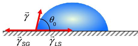
**Figure 2.16 - Tensions superficielles agissant sur la ligne triple d'une goutte de liquide déposée sur un substrat.**
