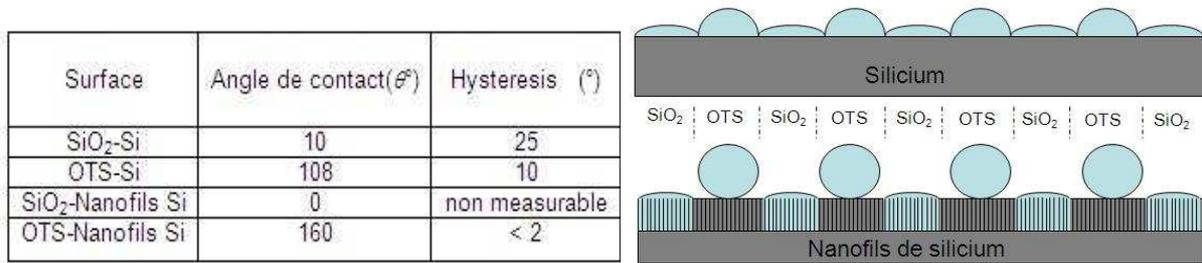
**Figure 5.17. Schéma des surfaces de silicium et de nanofils de silicium avec les zones 'SiO<sub>2</sub>/OTS' en coupe et tableau avec la valeur des angles de contact associés à chaque zone.**
