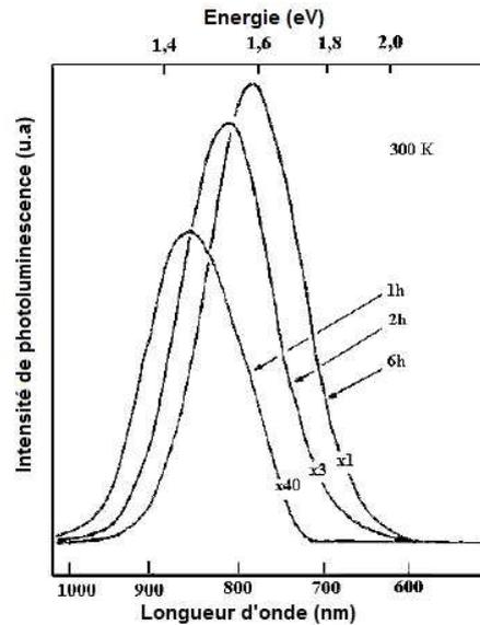
**Figure 2.24. Spectres de photoluminescence du silicium poreux après différents temps d'anodisation.**<sup>100</sup>
