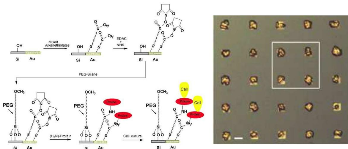
**Figure 5.4 - a) Etapes de fonctionnalisation des plots en or par de la fibronectine sur SiO<sub>2</sub> pour l'accueil des cellules et b) culture de cellules sur plots de 20µm x 20µm.**
