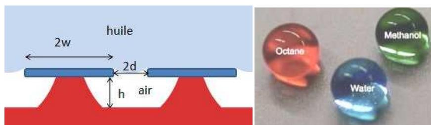
**Figure 4. Surface superoléophobe présentant des courbures ré-entrantes favorisant un piégeage d'air efficace. Photo de goutte d'ocane, d'eau et de méthanol à droite sur une surface superoléophobe.<sup>22</sup>**
