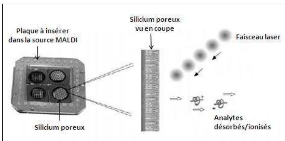
Figure 1.9. Schéma de principe du DIOS.
