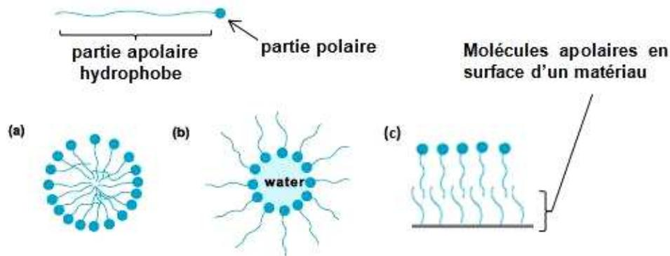
**Figure 2.14. Schéma d'une micelle formée par des molécules amphiphiles a) dans un milieu polaire, b) dans un milieu apolaire et c) schéma de l'adsorption de molécules amphiphiles par interactions hydrophobes avec les molécules apolaires en surface d'un matériau.**
