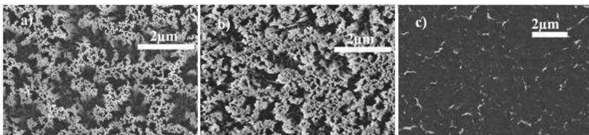
**Figure 3.12. Image MEB du support de nanofils de silicium optimisé pour les analyses LDI-MS avant oxydation a), après oxydation oxydation thermique complète des nanofils de silicium b), et après oxydation et attaque HF c).**
