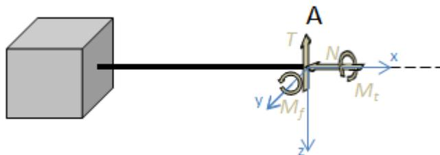
**FIG. I3 - 8** – Définition des efforts internes dans les poutres étudiées, et convention de signe (tous les efforts et moments représentés ici sont orientés positivement).  $T$  et  $N$  sont respectivement l'effort tranchant et l'effort normal.  $M_f$  et  $M_t$  sont le moment de flexion et le moment de torsion subis par la poutre.
