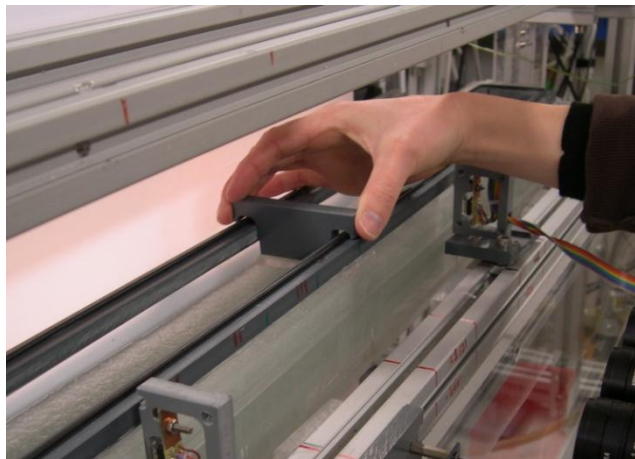
Figure II.4- Technique du lissage manuel de l'interface entre la fracture et la matrice poreuse.
