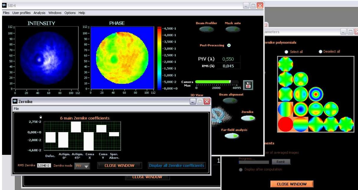
FIGURE VI.14 : Mesure des déformations du front d'onde de notre faisceau avant le passage du télescope. Coefficients de Zernike.
