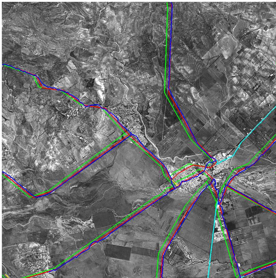
FIG. 2.84 – Résultat sur données réelles : le réseau extrait de l'image est en bleu, le réseau cartographique initial est en vert, le réseau cartographique après recalage est en rouge, les routes de l'image non appariées sont en bleu ciel et la route de la carte non appariée en jaune.
