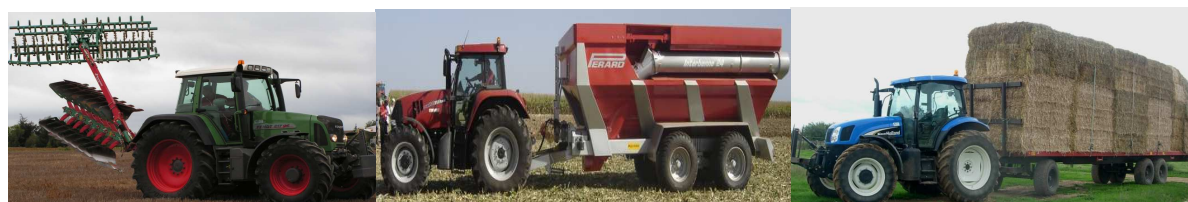
Figure 1.4a: outil porté/ b: outil semi-porté/ c: outil traîné
