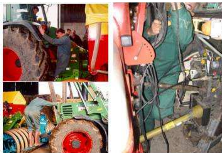
Figure 5.9 : Position et posture possible pour effectuer l'accrochage (MAP, 2006)
