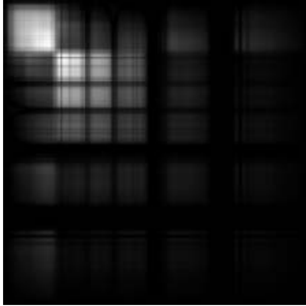
FIG. 1.5 – Image de la matrice de covariance d'une scène AVIRIS : l'intensité en un point (i, j) de l'image est la covariance entre les mesures dans les bandes de longueur d'onde i et j , c_{ij} = E\{x_s^i x_s^j\} .
