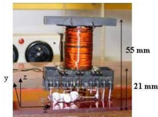
Figure 28 : Dispositif sous test (bobinage de 50 spires)
