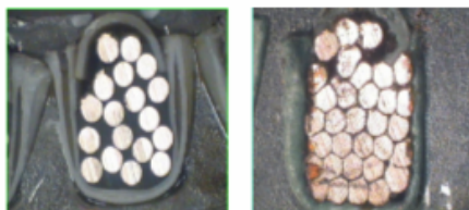
Fig. 4.12 : Evolution du coefficient remplissage de l'encoche stator
