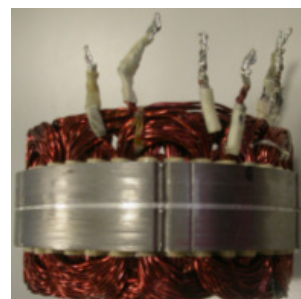
Fig. 4.20 : Couronne en aluminium [B1]
