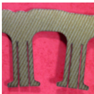
Fig. 4.19 : Fentes des dents du stator [B1]
