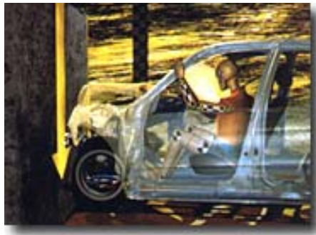
Figure 2.13 : Crash-test avec mannequin physique (réalisé par Renault).
