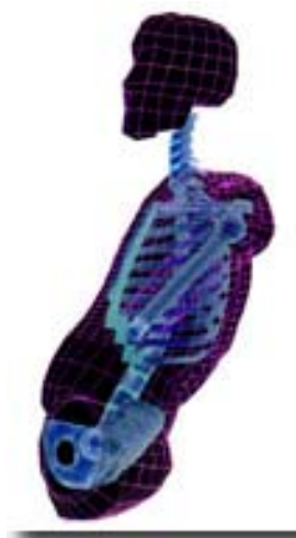
Figure 2.14 : Modèle éléments finis du corps humain pour la simulation de choc automobile.
