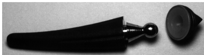
Figure 1.18 : Prothèse trapézo-métacarpienne (ARPE) utilisée pour la validation du calcul du centre de rotation.
