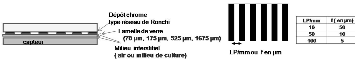
Figure 81- Schéma des expériences avec les réseaux de Ronchi.
