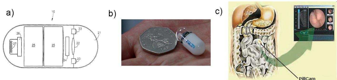
Figure 17- a) Schéma du brevet [77] : 21 Fenêtre optique, 22 Système optique (lentilles par exemple), 23 LED, 24 Capteur CMOS, 25 source d'énergie, 26 transmetteur, 27 antenne, b) PillCam sur une main, c) Schéma d'utilisation et fenêtre avec l' image d'endoscopie obtenue , d'après [77, 78]
