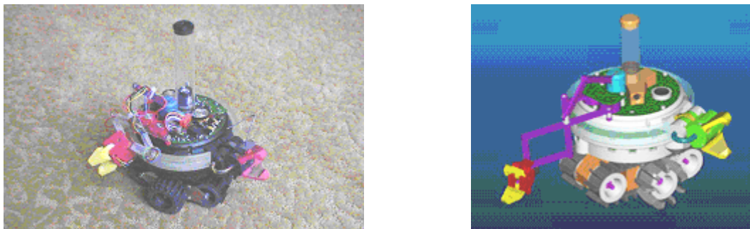
Figure 19 Le S-bot, réalisation matérielle et son modèle CAO
