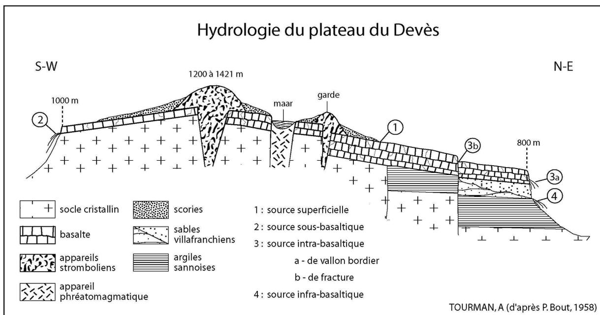
Figure 6 : Les différents types d'émergences basaltiques
