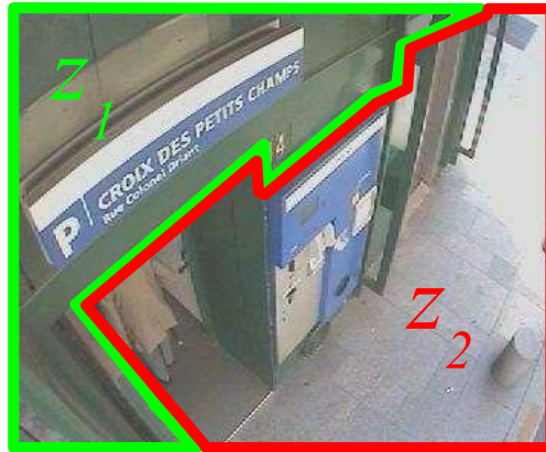
Figure D.1: Exemple de réglage local des paramètres basé sur une connaissance a priori de la scène filmée. La valeur du seuil de détection pour les pixels dans z_1 devrait être plus faible que celle pour les pixels dans z_2 .
