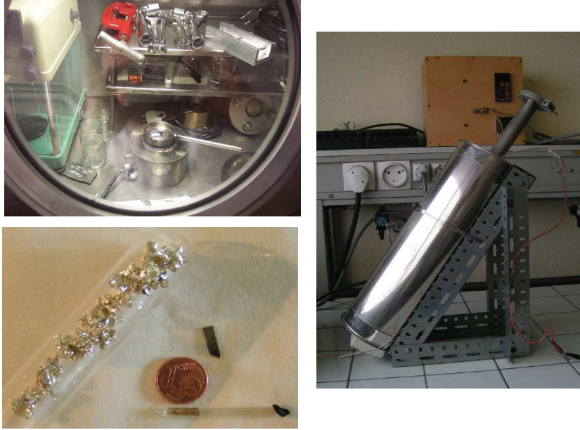
FIGURE 3.6 – Illustration des différentes étapes dans la synthèse de \text{CaC}_6 . Préparation sous boîte à gants de l’alliage lithium/calcium fondu. Immersion de l’échantillon de graphite dans l’alliage fondu. Le tube contenant l’alliage fondu est enfermé dans une chemise métallique sous argon placé dans un four électrique. Réactifs : calcium et fragment de graphite, et échantillon de \text{CaC}_6 dans un tube scellé. Photographies : C. Hérold et N. Emery, LCSM Nancy
