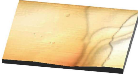
FIGURE 3.7 – Image topographique de la surface clivée de CaC 6 . Le champ total correspond à 180nm * 150nm. La différence de hauteur totale est de 15nm. D’après Bergeal et al. [83]
