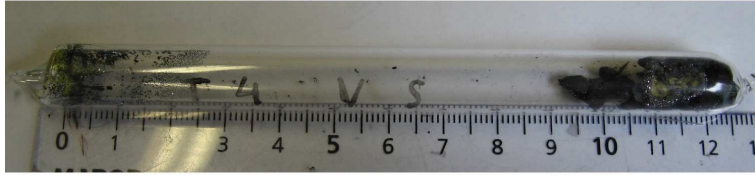
FIGURE 2.10 – Résultat d'une synthèse dans un tube de silice . L'excès de chalcogène (soufre) s'est condensé dans la partie gauche du tube. [3]
