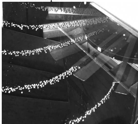
Figure 2-2 : Photographie multi-exposition d'un flux de granules d'ammonitrate sur la pale et à la sortie de la pale d'un disque d'épandage centrifuge. L'éclairage stroboscopique permet l'observation de 5 positions successives de la pale.
