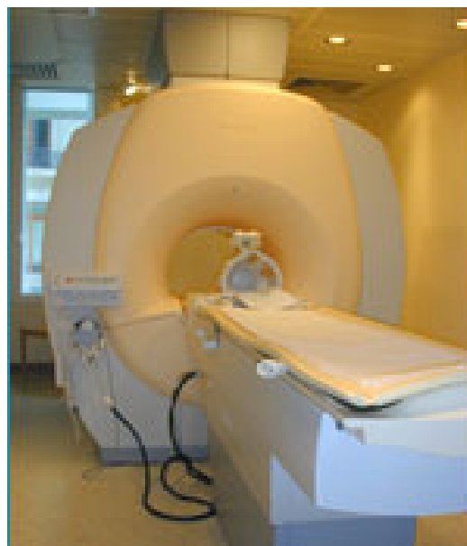
Figure 15. Machine d'IRM à aimant supra-conducteur (1.5 Tesla)
