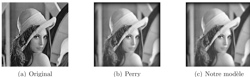
FIG. 5.6 – Comparaison des résultats des filtres passe-bas spatialement variant du modèle de Perry avec le paramètre contrôlant la vitesse de décroissance de l'échelle \alpha = 2.3^\circ et de notre modèle. Le point de vue est au centre de l'image.
