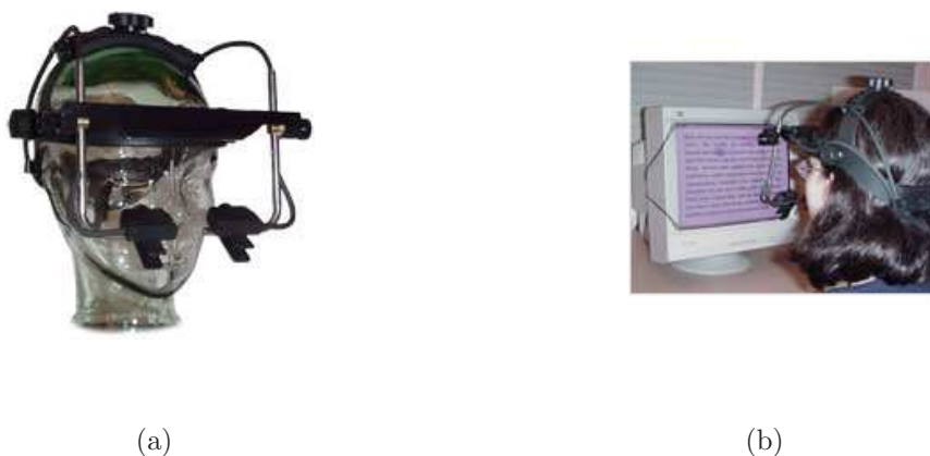
FIG. C1 – Un casque permet d’enregistrer des fixations lors de l’expérience de mouvements oculaires ( http://sr-research.com/EL-II.html ). (a) Un casque ; (b) Un sujet muni d’un casque lors d’une expérience oculométrique.
