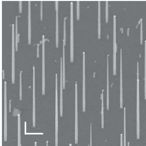
Fig. 1.14: Vue MEB de NFs Si obtenus en UHV-CVD sur substrat Si(111), avec l'or comme catalyseur et le disilane \text{Si}_2\text{H}_6 comme précurseur gazeux. D'après [41].
