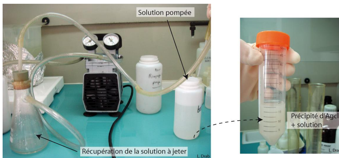
Figure A11 : Pompage de la solution contenant l'échantillon dissout dans l'acide nitrique. L'ajout de nitrate d'argent a permis la précipitation de chlorure d'argent, qui est récupéré dans un tube à essai après que la solution ait été pompée.
