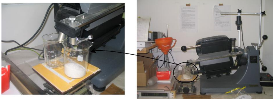
Figure A2 : Photographie du séparateur magnétique (Franz) utilisé, qui permet d'ôter les particules diamagnétiques, dans le bécher en noir et de récupérer les particules diamagnétiques, dans le bécher de droite, en blanc.
