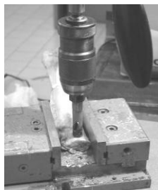
Figure II-2 - protocole d'extraction d'échantillons cylindriques : « carottage » d'une côte.
