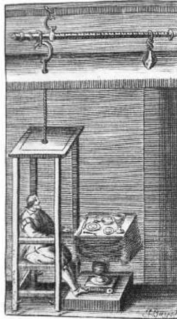
Figure 1.1. La balance métabolique imaginée par Santorio Sanctorius pour l'étude de la "transpiration invisible". Tiré de De Statica medicina , 1690 (Eknoyan, 1999).
