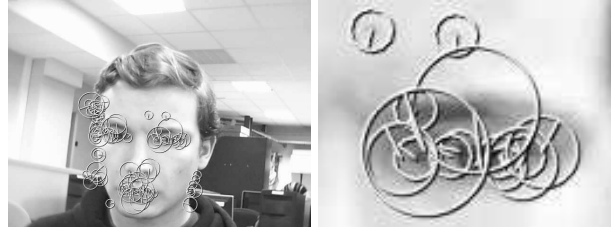
FIG. II.7: Exemple de SURFs sur un visage - Zoom sur un œil - Les cercles représentant les SURFs sont centrés à l'emplacement de chaque point d'intérêt, le rayon correspond à l'échelle du SURF et le trait matérialise son orientation.
