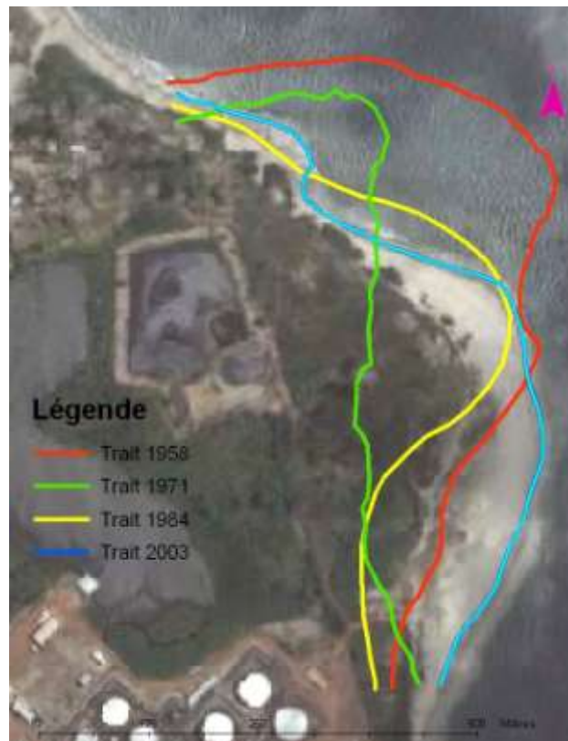
Figure 63 : Zones F et G. représentation des positions successives du trait de côte entre 1958 et 2003
