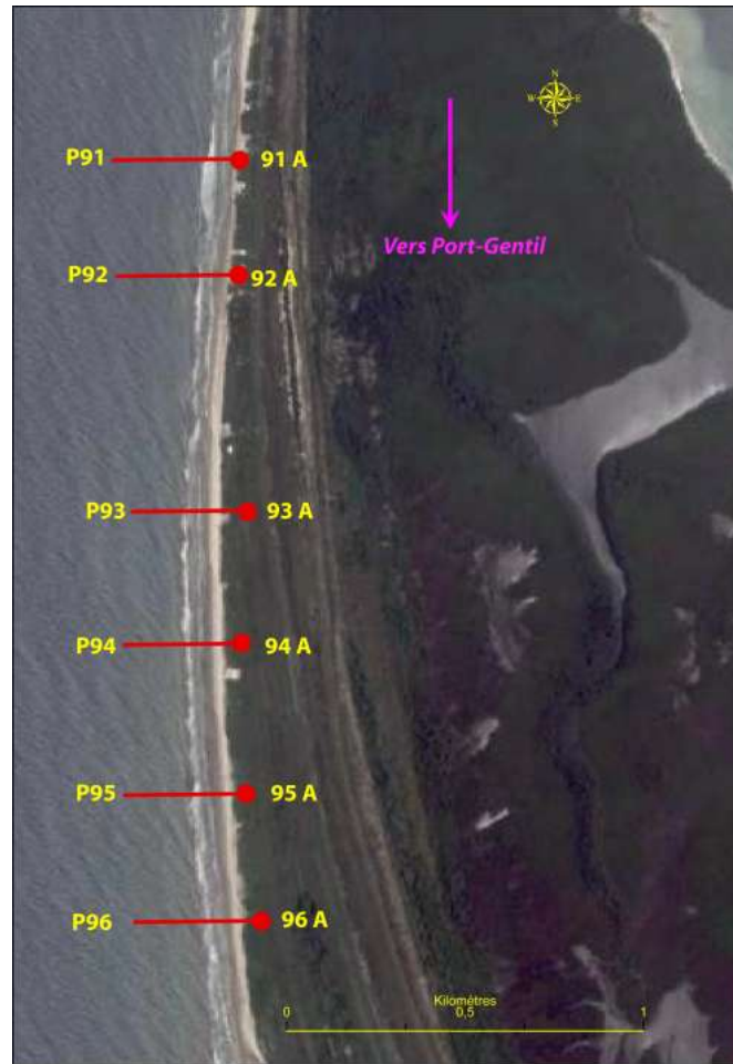
Figure 55 : Profils de suivi de la courbe +2 m, zone Sud du phare (Spot Image cat. ID= 101001001COFE01, 29/03/2003)
