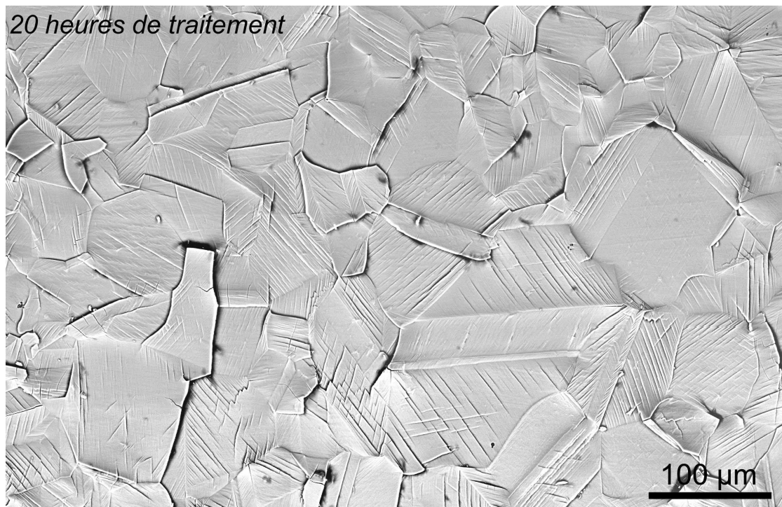
Figure 62: Images MEB de la surface d'échantillons niturés 1, 3 et 20 heures (assemblages d'images réalisées avec les électrons rétrodiffusés, au grossissement 1000).
