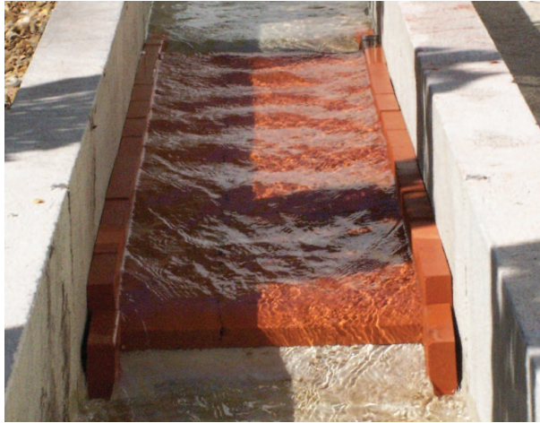
FIGURE 5.22 – Ondulations de la surface libre observées lors des mesures pour la configuration « Briques ».
