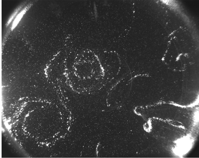
Figure 7.1: Observation du changement d'état de l'écoulement. On peut distinguer les vortex localisés près des parois. A une certaine valeur du forçage, des jets radiaux provenant des parois latérales pénètrent dans le coeur de l'écoulement dominé par la rotation solide et le forçage des modes azimuthaux m=1 . Les jets deviennent des structures en champignon qui s'enroulent pour former des vortex.
