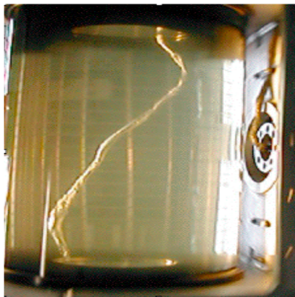
Figure 5.8: Comparaison entre simulation numérique de la distribution de la pression du mode forcé par la précession (à gauche) et la visualisation directe de l'écoulement par bulles d'air (à droite). On a volontairement tourné de \frac{\pi}{2} l'image de droite par soucis de clarté mais le vortex s'aligne sur celui de l'axe de rotation.
