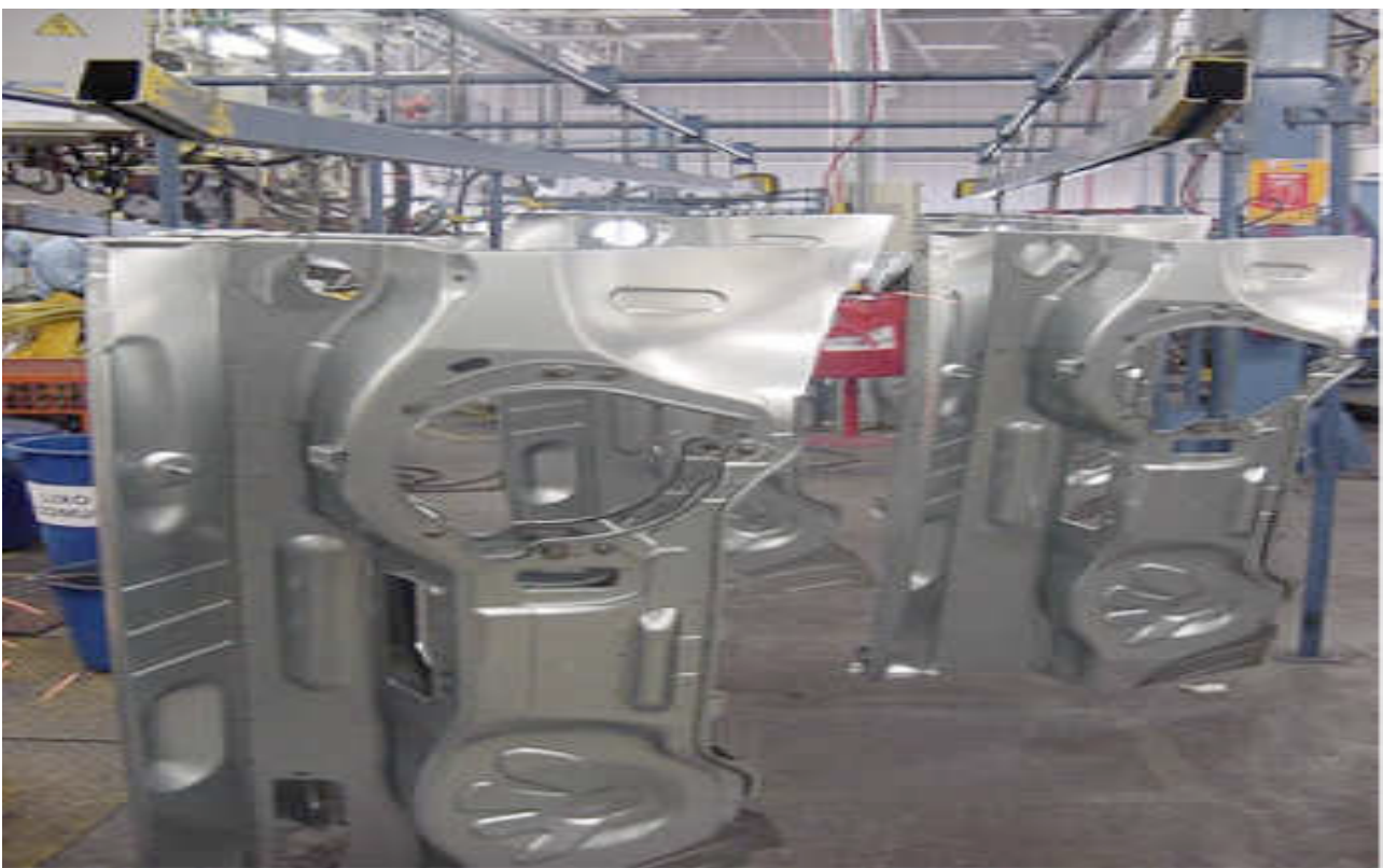
Photographie II.1 : « Dispositif manuel de transfert ».
