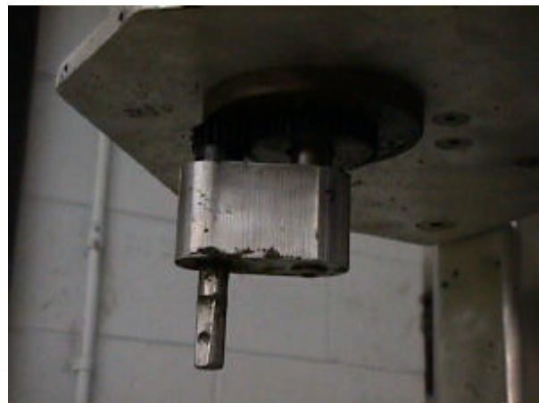
(d) Détail du dispositif de rotation planétaire
