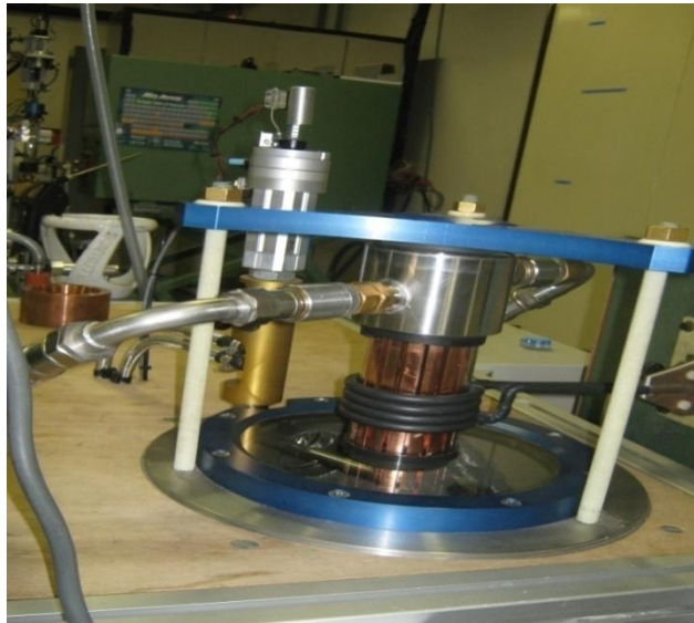
Figure II.1 : Four HF, avec son creuset froid, utilisé pour la réalisation des échantillons massifs.
