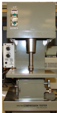
Figure 38. Configuration standard du module de compression KES-FB3
