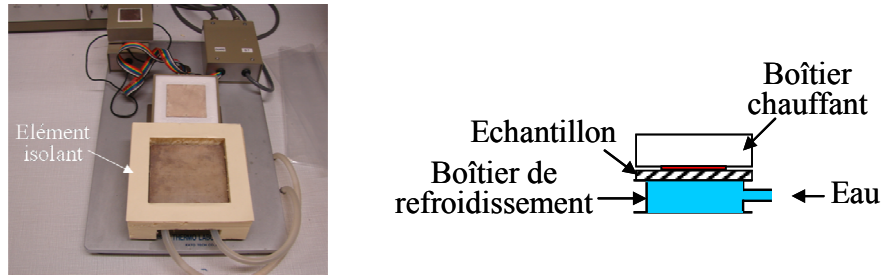
Figure 164. Configuration personnalisée du test de conductivité thermique
