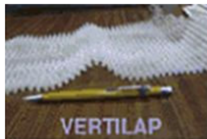
Figure 14. Structure du nouveau non-tissé 3D VERTILAP® avant condensation des plis [41]
