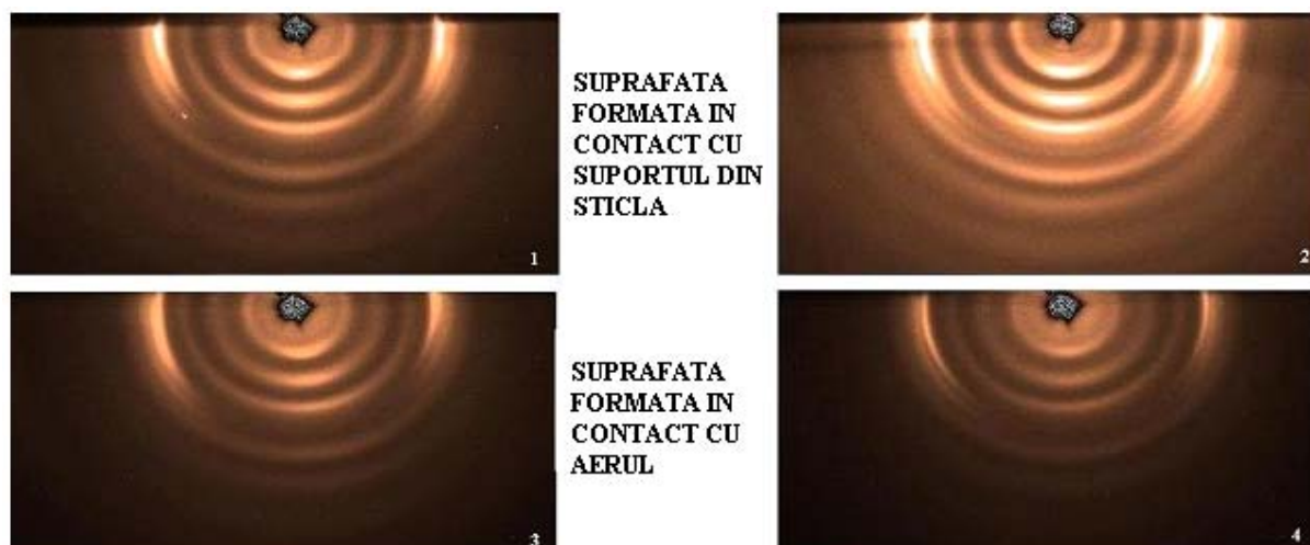
Figura 16. Difractograme bidimensionale WAXS, realizate in mod unghi razant, asupra suprafețelor formate in contact cu aerul și in contact cu suportul din sticlă a două filme de PANI de grosimi diferite. Aceste difractograme au fost realizate cu o înclinare de 0.2^\circ in raport cu orizontala. Imaginile 1 și 3 sunt reprezentative pentru un eșantion cu grosimea de 60 \mu\text{m} , iar imaginile 2 și 4 sunt reprezentative pentru un eșantion cu grosimea de 130 \mu\text{m} .
