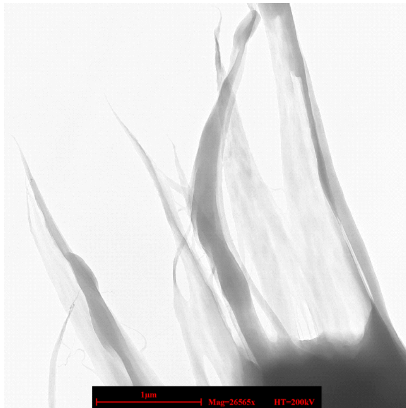
Figura 21. Diffractogramă (obținută prin difracție de electroni) și imagine de MET a unei suspensii de polianilină dializată.
