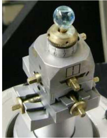
FIGURE 2.6 – Photographie de la sphère de YCOB : Nd collée sur sa tête goniométrique.
