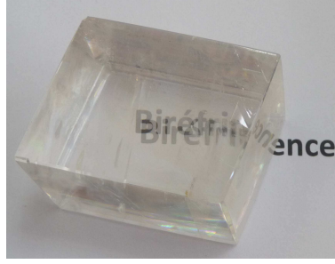
FIGURE 1.6 – Dédoublage d'une image à travers un cristal de Calcite par le phénomène de double réfraction.
