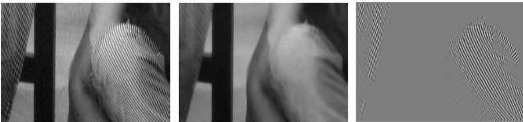
FIG. 2.10 – Exemple de séparation : à gauche, l'image originale ; au centre, la géométrie ; à droite, la texture
