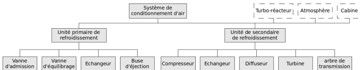
Figure 11 : Organigramme technique définissant la décomposition organique d'un système de conditionnement d'air dans un avion.
