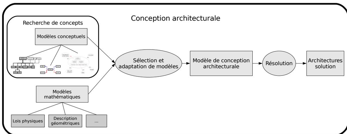
Figure 7 : Cheminement des modèles en conception préliminaire.
