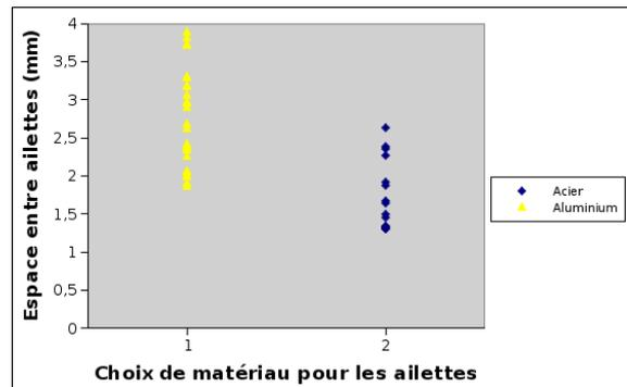
Figure 23 : Solutions en fonction du matériau utilisé et de l'espacement des ailettes.
