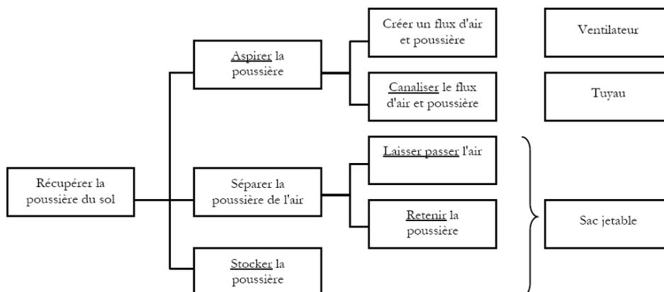
Figure 8 : Exemple de diagramme FAST d'un aspirateur ménager.
