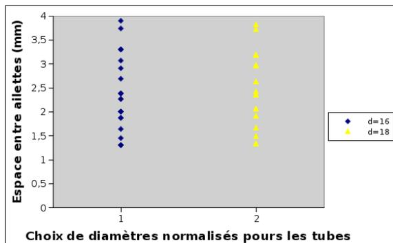
Figure 24 : Solutions en fonction des diamètres normalisés des tubes et de l'espacement des ailettes.
