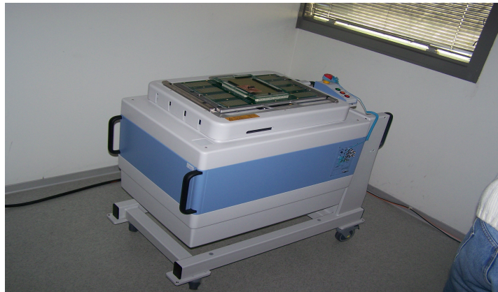
FIGURE 2.2 – ATE avec broches RF du CNFM Montpellier.
