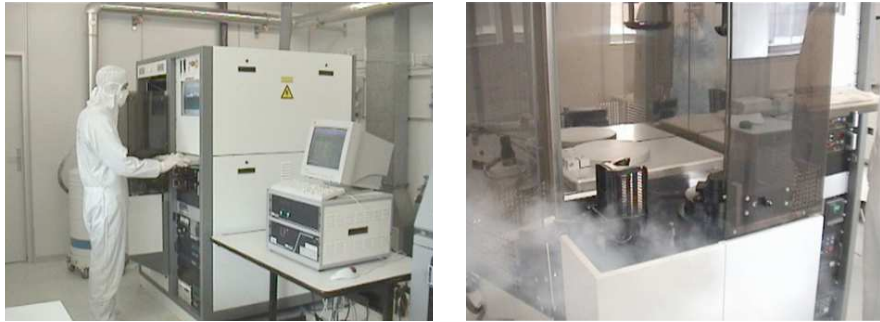
FIG. 4.5 – Equipement de gravure profonde de type " Deep Reactive Ion Etching" (DRIE). Système ALCATEL 601E.
